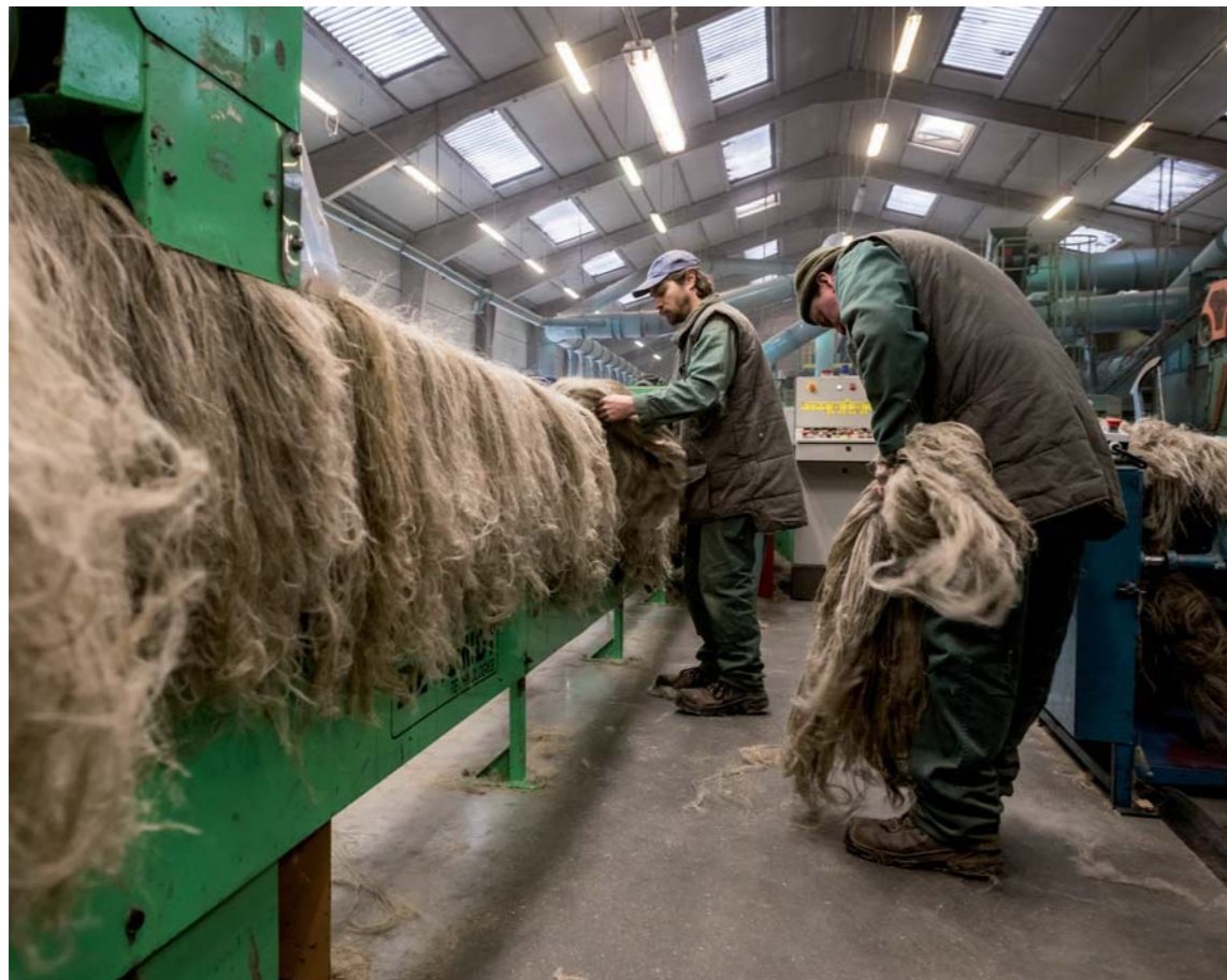
LE FIBRE A TIGLIO LUNGO, SELEZIONATE A MANO ALL'USCITA DALLE TURBINE, VENGONO CLASSIFICATE SULLA BASE DELLE CARATTERISTICHE E DEL COLORE
